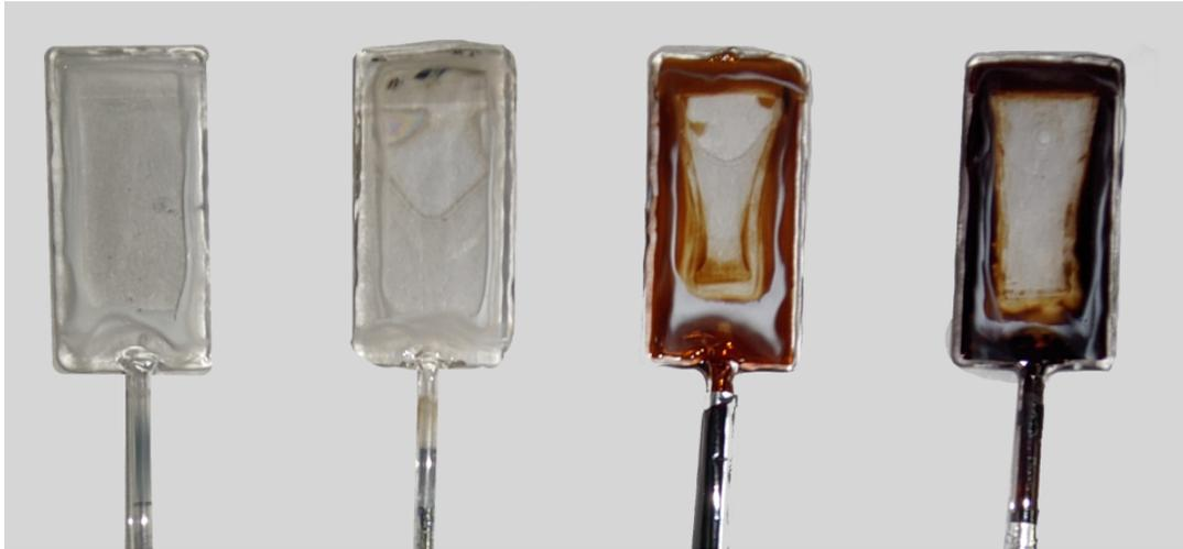
Abbildung 11.3: Die Zelle wird unter Einwirkung von Hitze (ca. 280 °C maximal) zunehmend braun, wodurch die Transmission abnimmt.
