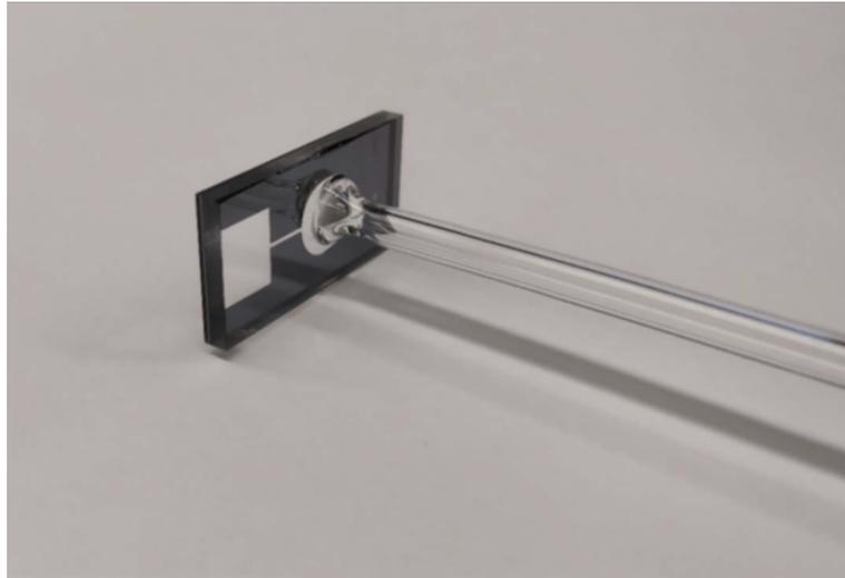
Abbildung 3.1: Foto der verwendeten MEMS-Zelle. In dem angebrachten Glasrohr befindet sich festes Rubidium, dessen Dampfdruck innerhalb der Zelle durch Erhitzen gesteuert werden kann.
