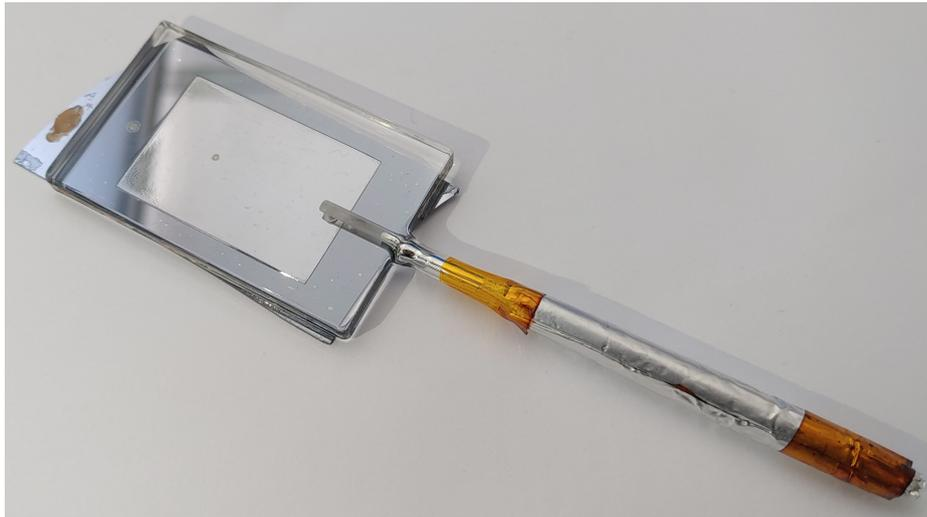
Abbildung 4: Photo der untersuchten Zelle. In der Halterung (sogenanntes Reservoir) befindet sich festes Rubidium, von dem beim Erhitzen ein Teil flüssig und auch gasförmig wird. Dieses Rubidiumgas verteilt sich in der Zelle.
