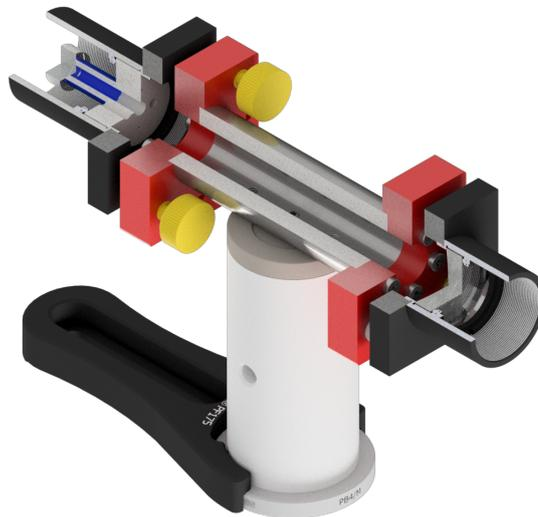
Abbildung 2.4: Es ist das technische Design des verwendeten optischen Resonators abgebildet. [11]
