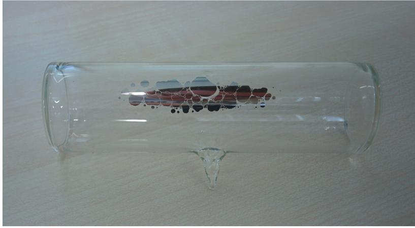
Abbildung 10: Bild der verwendeten Zelle. Diese ist 12 cm lang und hat ein natürliches Verhältnis von  $^{85}\text{Rb}$  zu  $^{87}\text{Rb}$ .
