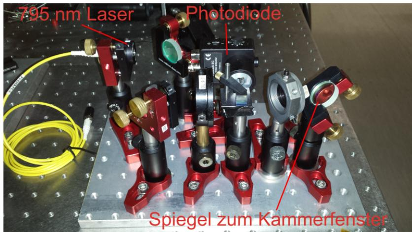
ABBILDUNG 15: Aufbau zur Einphotonenspektroskopie. Die Reflexion aus dem Kammerfenster wird durch den polarisierenden Strahlenteiler auf die Photodiode abgelenkt.
