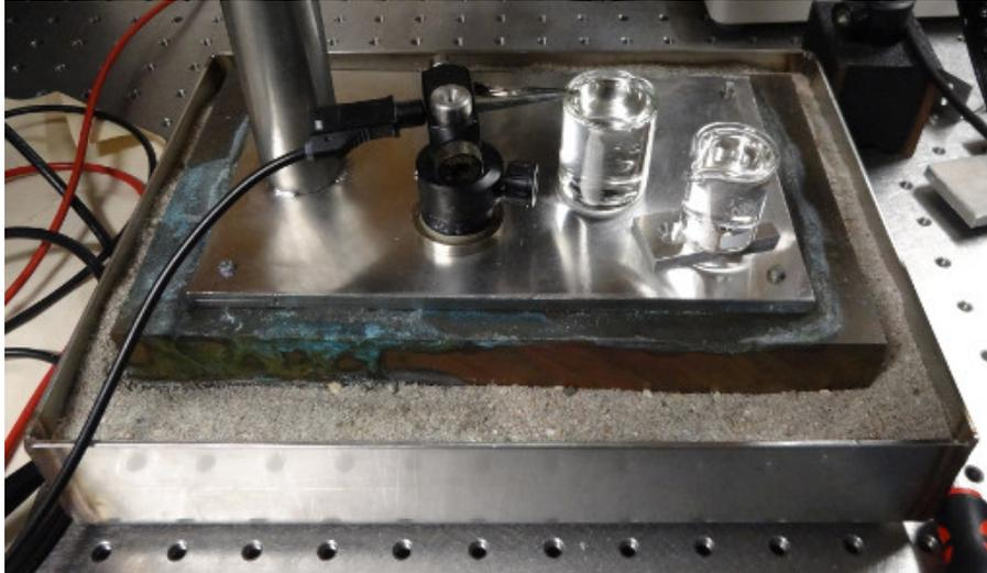
Abb. 3.19.: Stoßisolierung der Ätzapparatur mit Sand, Sorbothan und optischem Tisch.
