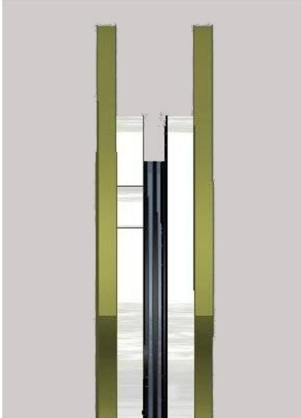
Abb. 4.2.: MCP-Halterung ohne Phosphorschirm; Computer 3D-Zeichnung.
