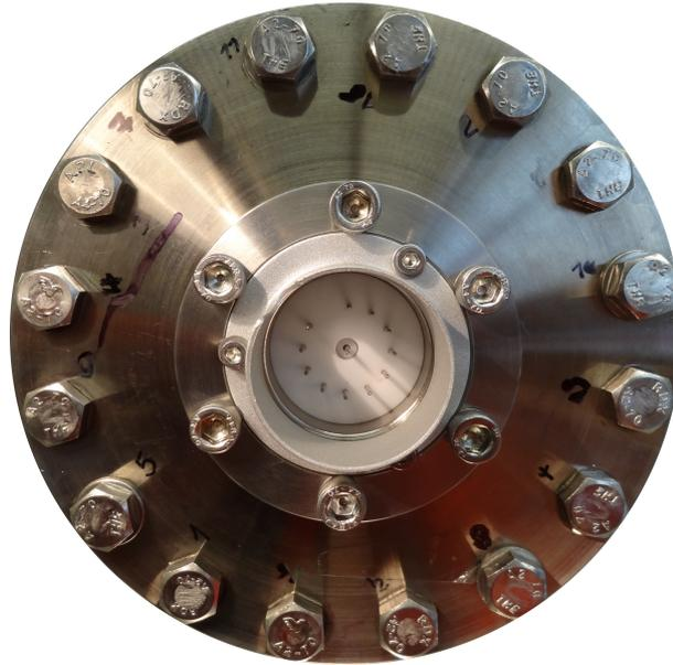
Abb. 5.2.: Flansch mit eingebautem Plugverbindungsstück
