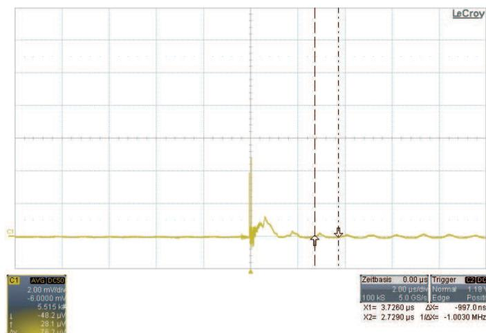
**Abbildung 3.7:** Der Screenshot des 1-GHz LeCroy Oszilloskops zeigt einen 80ns-Puls bei  $\lambda$ -Spannung. Nach dem eigentlichen Doppelpuls (bei  $t \approx 0$ ) ist ein Nachpuls mit einer Dauer von  $\sim 1 \mu\text{s}$  und eine Schwingung mit einer Periode von  $\sim 1 \mu\text{s}$  zu erkennen.
