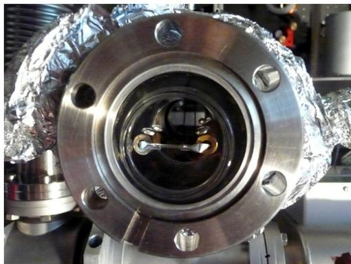
Abbildung 14: Der Dispenser liegt in einem Duran-Glasrohr, welches einen Kurzschluss der Zuleitungen mit der Wandung der Kammer verhindert.
