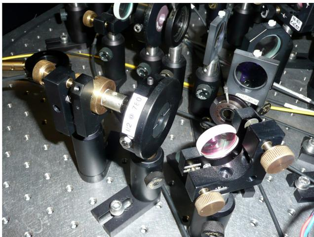
Abbildung 16: Die zusätzliche Verzögerungsplatte ( $\lambda/2$ ) vor dem Einkoppeln des MOT-Lasers in die Glasfaser sorgt für eine bessere Kontrolle der Polarisation in der Faser und macht sie unempfindlicher gegen äußere Einflüsse wie Temperaturschwankungen, Stöße, etc.
