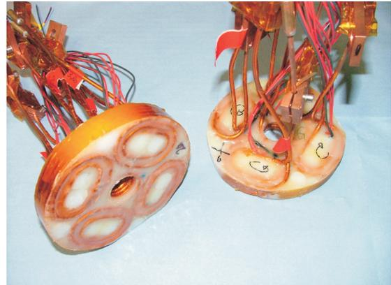
In Abbildung 2.6 ist das Design, in Abbildung 3.18 die Realisierung der Clover-Leaf-Magnetfalle gezeigt. Die Spulen bestehen aus einem mit Kaptonband isoliertem Kupferrohr mit einem Außendurchmesser von 4mm.
