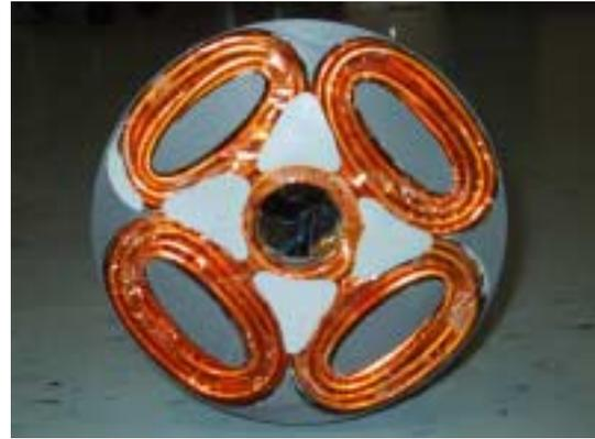
Abbildung 3.29.: Fertiges Spulenpaket.
