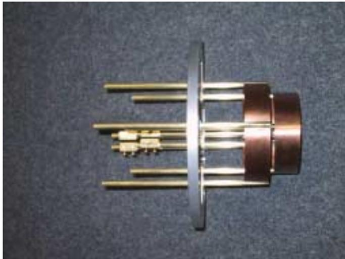
**Abbildung 3.30.:** Das bewegliche Spulen-Paar mit Haltevorrichtung.
