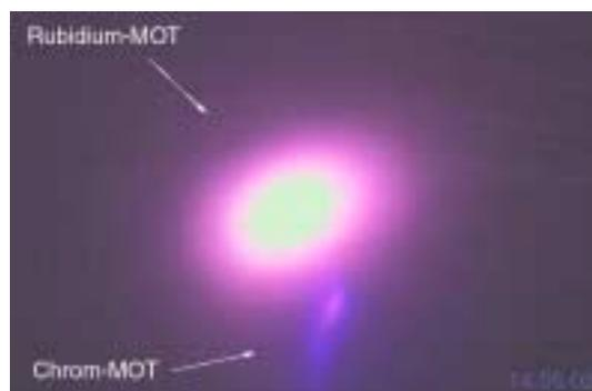
**Abbildung 7.1.:** Eine der ersten Fotografien der beiden leicht gegeneinander verschobenen MOTs. Die Echtfarben Aufnahme wurde mit einer gewöhnlichen USB-Webcam mit aufgesetztem 300mm Objektiv und aufgeschraubter Macro-Linse genommen.
