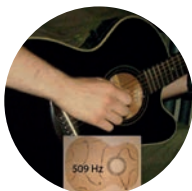
Die Abbildung zeigt das Resonanzbild auf dem Gitarrendeckel, wenn es mit 509 Hertz beschallt wird.
