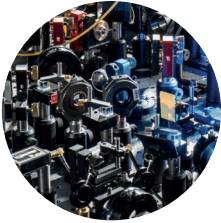
Ein Labyrinth aus Spiegeln auf einem optischen Tisch bringt Laserstrahlen in die gewünschte Form und Farbe, die für Experimente mit Atomen benötigt wird. Foto: Wolfram Scheible
