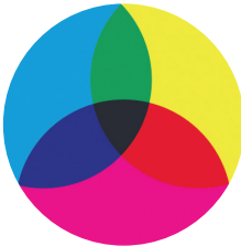
Subtraktive Farbmischung mit den Grundfarben Cyan, Magenta und Gelb oder abgekürzt CMYK.
