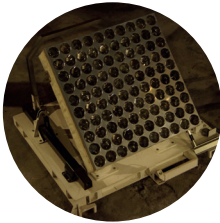
Replik des Laserreflektors von Apollo 11, der 1969 auf der Mondoberfläche installiert wurde.
