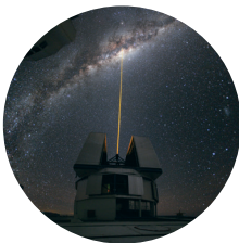
Laser am Paranal-Observatorium mit dem in 90 km Höhe in der Mesosphäre der Erde ein künstlicher Stern erzeugt wurde. Foto: ESO/Yuri Beletsky
