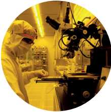
Reinraum des Instituts für Großflächige Mikroelektronik an der Universität Stuttgart. Gelbes Licht verhindert, dass UV-Licht auf die Photolacke fällt, mit denen kleinste Strukturen realisiert werden können. Foto: IGM
