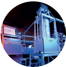
Seit 1967 beruht die Basis-einheit der Zeit auf einer Eigenschaft von Cäsium-Atomen. Die vier Primärurhuren der Physikalisch-Technischen Bundesanstalt PTB gehen mit einer Genauigkeit von 16 Stellen hinter dem Komma. Foto: PTB
